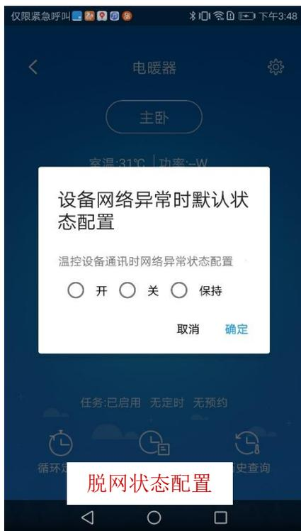
小二组合的两个设备，任何一个设备掉网，就会造成两个设备无法关联，即温湿度通讯不能送达，无法让电器进行正常的温湿度控制，因用户对电器的开关状态需求不一样，我们允许用户在APP上根据个人判断，预置设备因掉网而造成通讯异常时电器的工作状态：
