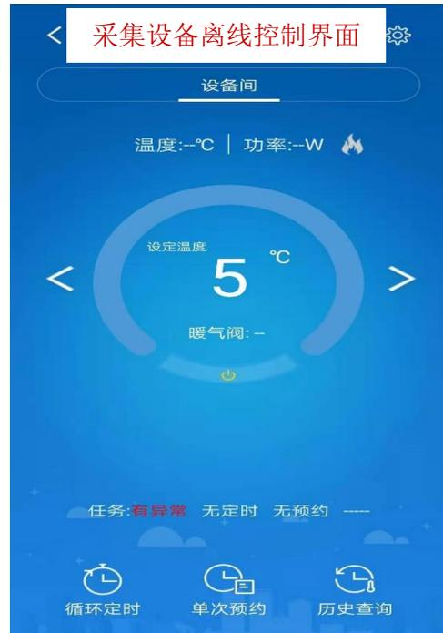
2、如果只有伴侣设备掉网（蓝灯快闪）时：控制界面有室温显示，但是页面为黑灰色，无法进行调温控制。电器的状态会遵循用户设置的设备离线状态配置，直到设备再次上网。
