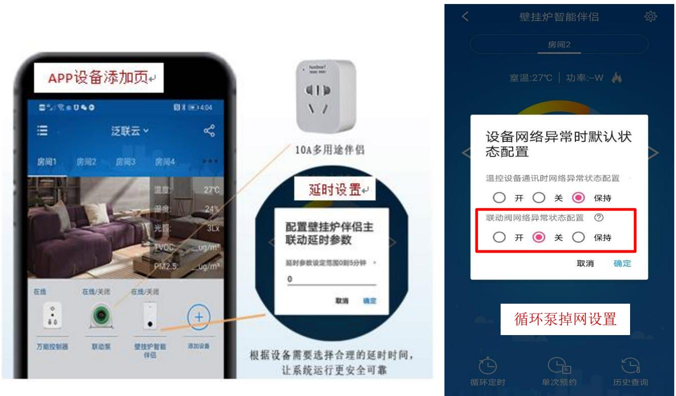
操作方法：按第四条的方法将多用途温控器小二组合、壁挂炉智能伴侣添加到APP上，多用途智能伴侣与壁挂炉智能伴侣放在同一房间，采集设备放任意房间，多用途伴侣选择循环泵用途，点击循环泵，进入循环泵控制页面，循环泵会自动与壁挂炉智能伴侣设备关联联动，然后进入壁挂炉智能伴侣的控制页面操控壁挂炉，循环泵就会与壁挂炉无延迟联动，点击右上角的设置键，进入“配置壁挂炉主联动延时参数，根据泵的要求，输入0-5分钟的延时参数（一般设置为1分钟）。
