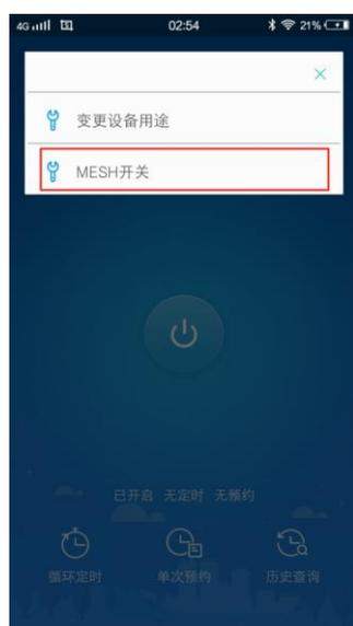
注： mesh 开启后，设备断电重新上电，设备会有几分钟处于组网状态。用户需要等待几分钟后才可以使用
