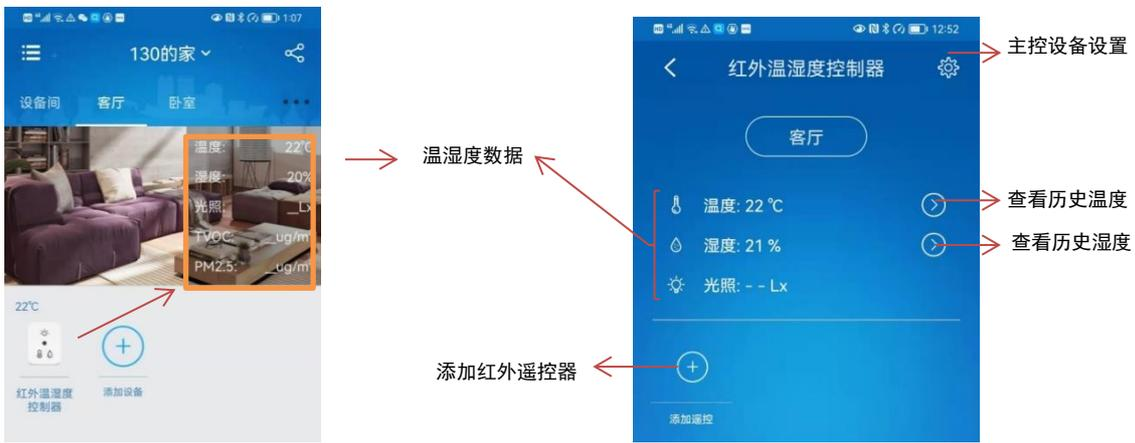
若房间没有其他采集设备（一个房间一般只放置一个采集设备），且房间有做温湿度控制用途的伴侣设备(比如电暖器、暖气阀及空调等)，进入伴侣设备时，两设备会自动关联做温湿度控制（究竟控制温度还是湿度，由伴侣设备选择的用途决定），温湿度的调控将在伴侣设备的控制页面上进行，桌面面板可对主控设备进行同步控制（空调除外）。
